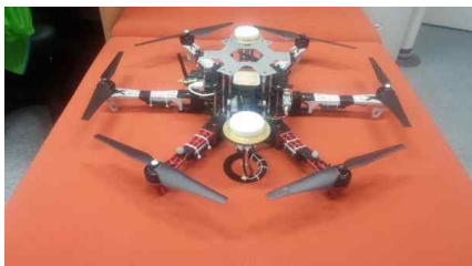
그림 2. 2-안테나 RTK D-GPS 장착 멀티로터 드론
